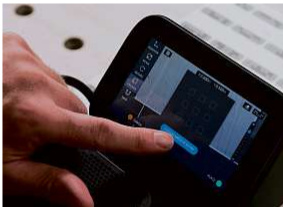
Bei der Handfräse Origin von Shaper kann der Fräspfad dank On-Tool-Designsoftware direkt auf dem Touchscreen angelegt werden.
